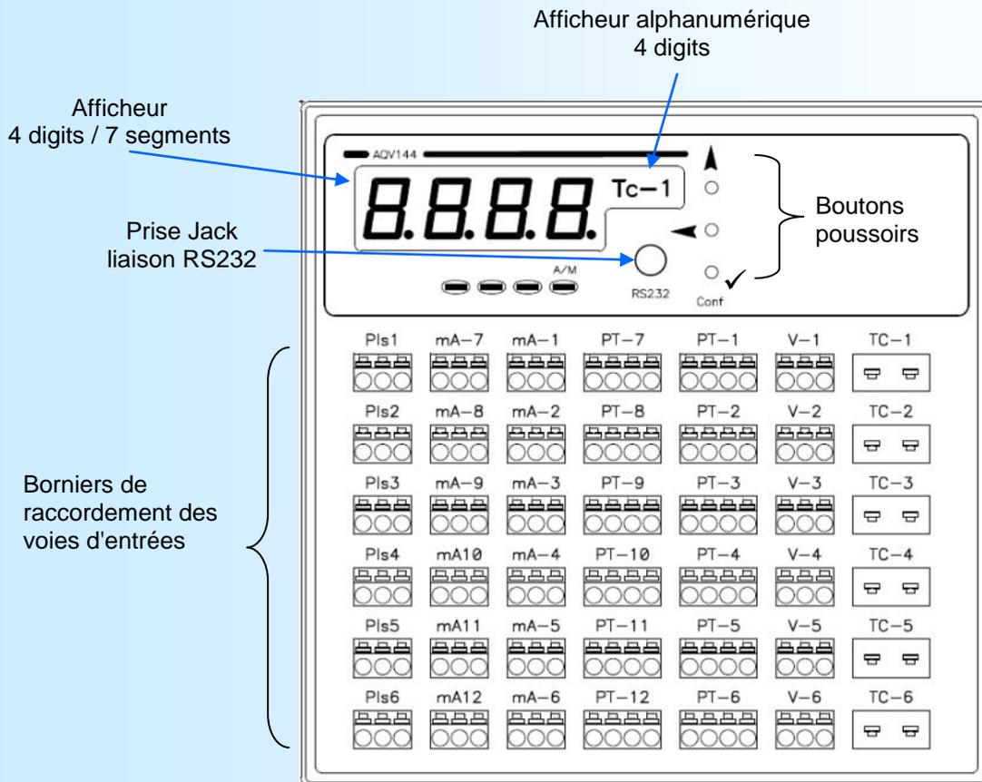
La face avant de l'appareil est composée de:
